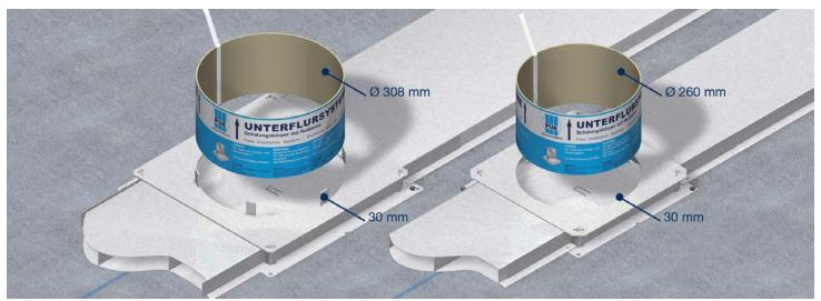
Hohlraumbodendosen für runde Einbaueinheiten Ø 305 mm oder Ø 258 mm und Unterflurkanäle bis 250 mm oder 350 mm Breite, in den Höhen 28/38/48 mm. Mindestestrichüberdeckung von 35 mm beachten.
